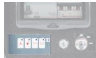
Scheda protezione motore: Alta temperatura motore; Bassa pressione olio; Basso livello carburante; guasto alternatore caricabatteria
