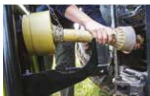
Accoppiamento cardanico con portagiunto per un montaggio sicuro
