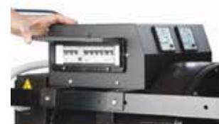
Versione IP 44 - con protezione contro la penetrazione di solidi più larghi di 1 mm e contro la penetrazione di liquidi
