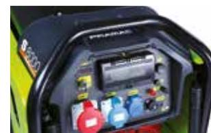
Display digitale con frequenzimetro, voltmetro e contatore. CONNettore per quadro commutazione e protezione differenziale o isometer a richiesta
